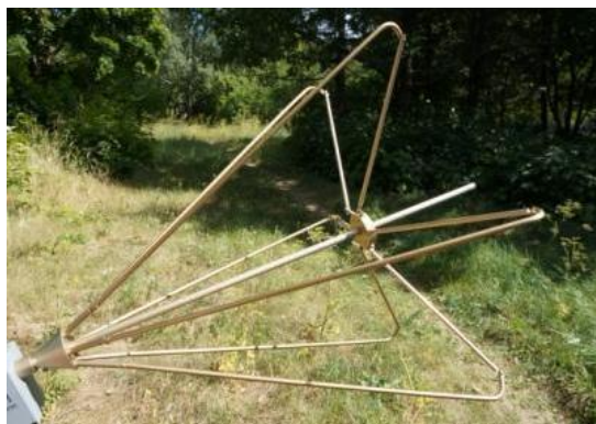
Фото 4. Антенна П6-121 на стадии сборки
