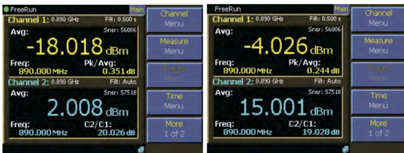
Рис. 8.3.4. Двухканальные измерения, показывающие падение усиления усилителя (отношение уровня на канале 2 к уровню на канале 1) на 1 дБ
