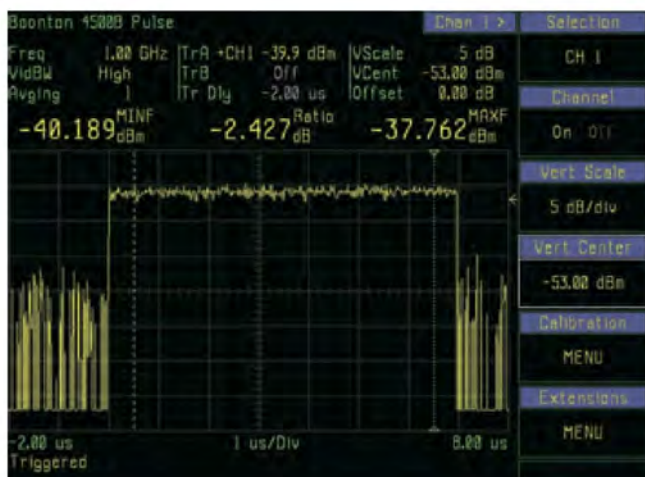
Рис. 3.2.1. Снимок экрана профиля импульса измерителя 4500B
