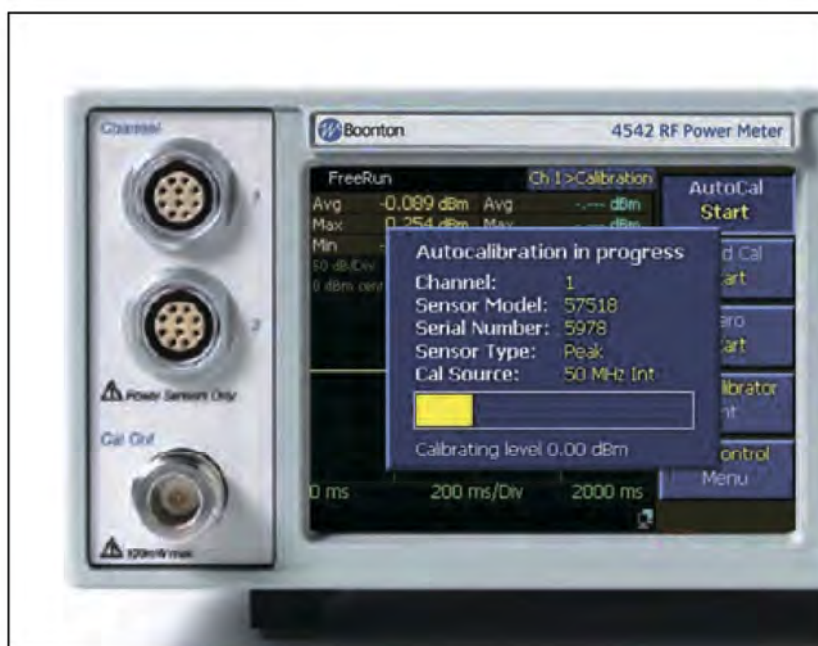
Выполнение автоматической калибровки датчика
