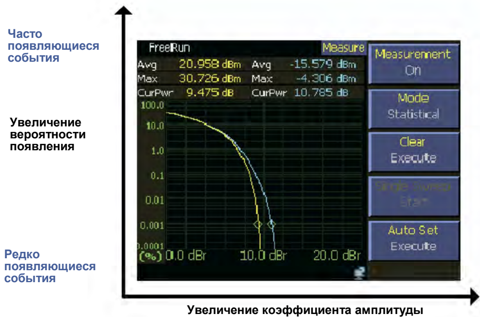
Рис. 7.2.7. Отображение "входной/выходной" функции CCDF показывает, что выход имеет уменьшенный коэффициент амплитуды, что указывает на сжатие сигнала
