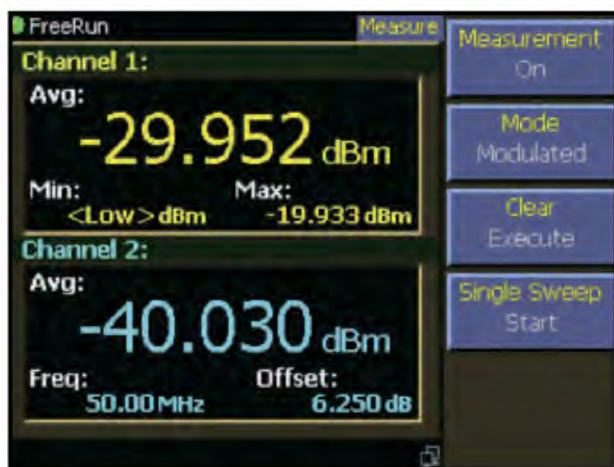
Типовые экраны для режима измерения модулированных сигналов (Modulated)
