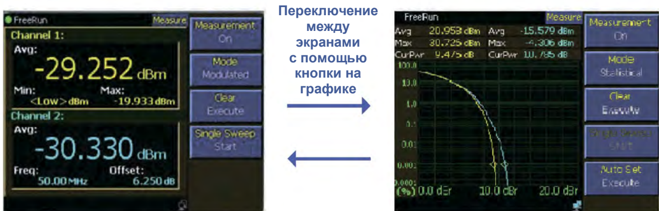
Рис. 8.3.8. Разница между стандартным анализом (пиковых и средних значений) и статистическим анализом с использованием функции CCDF
