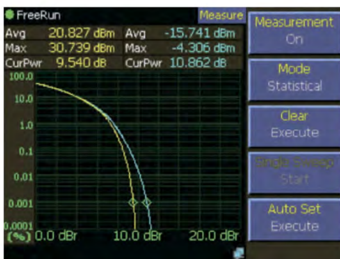
Рис. 6.3.2. Двойная CCDF: вход усилителя на канале 2 (синяя кривая справа) и выход усилителя на канале 1 (желтая кривая слева)
