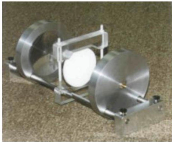
Резонатор модели 600 с контрольным образцом, 15 ... 110 ГГц
