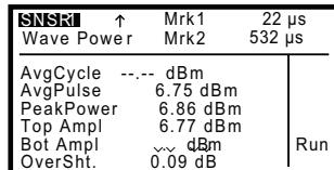
В отличие от ручных курсоров, автоматическое стробирование по времени позволяет отделить время начала и окончания пакета от перепадов при переходах и выполнить измерения в заданной пользователем части этого временного интервала.
