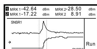
В ИМПУЛЬСНОМ режиме графический дисплей позволяет отображать измеряемые сигналы в реальном времени в формате осциллографа, которые при необходимости можно растягивать или сжимать.
