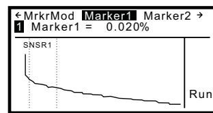
Просмотр статистических данных в виде функции CCDF позволяет тщательно проанализировать вероятность появления очень редких пиков, которые вносят определенный вклад в значение абсолютной пиковой мощности.
