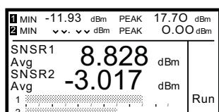
В МОДУЛИРОВАННОМ режиме на текстовом дисплее отображается истинная средняя мощность в обоих каналах плюс результаты отслеживания мгновенных пиковых и минимальных значений.
