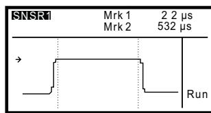
Экранные курсоры легко устанавливаются над активной частью отдельного таймслота GSM, обеспечивая измерение средней мощности и пик-фактора в течение этого интервала.
